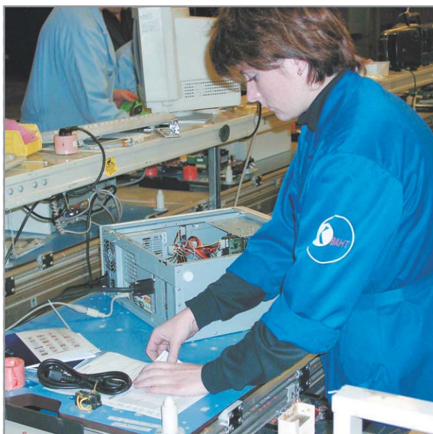
◀ Заключительный этап сборки — компьютер еще не подключен к электросети
