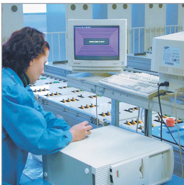
◀ В полностью собранные и подключенные компьютеры загружается специальное тестовое программное обеспечение — с этой минуты любой малейший сбой в работе компонентов будет зарегистрирован
